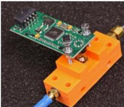
图 1: 带 XEN-5310 安装的 ABS 流量适配器, 没有带盖子的传感器元件
