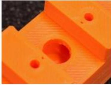
图 3: 直径为 4.5mm 的流量通道的近距离图, 带有直径为 7.6mm (没有盖子的敏感元件) 或者 8.3mm(带过滤盖子的敏感元件)的传感器空腔。带有 M3 螺纹的 2 个孔, 可以扣紧传感器板子。
